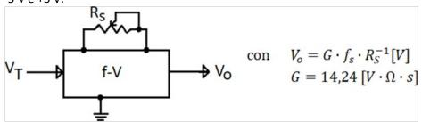
Infine il segnale  $V_0$  deve essere convertito mediante un ADC per consentirne la successiva acquisizione da parte di un sistema programmabile.
